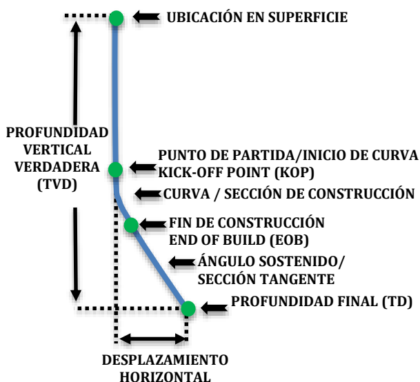
Figura 1: Parámetros clave en la perforación direccionada.
