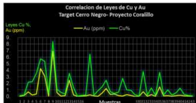
Fig 4. Gráfico de leyes, canales y chip rock, mostrando la correlación entre los valores de Cu y Au.
